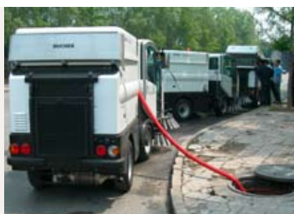
Les réservoirs d'eau des balayeuses sont remplis directement à partir des réservoirs municipaux.
