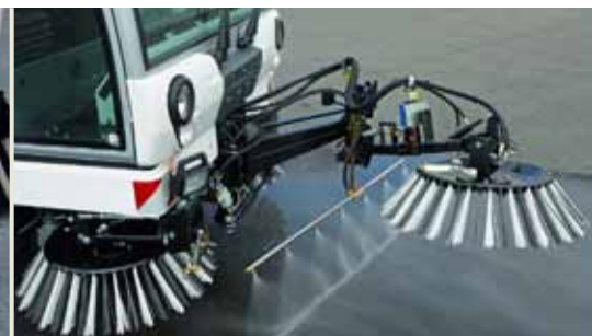
Le circuit de lavage
