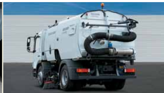
Tuyau d'aspiration flexible pour les endroits difficilement accessibles
