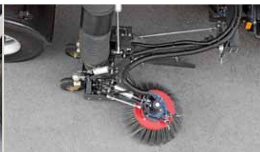
Largeur de travail flexible – agrégat d'aspiration télescopique
