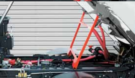
Béquille de sécurité à plusieurs positions
