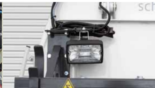
Phare de travail à l'arrière de la cuve à déchets – en option
