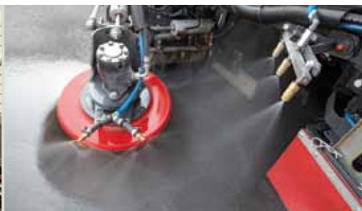
Buses de pulvérisation pour lier parfaitement la poussière (PM 10) – en option
