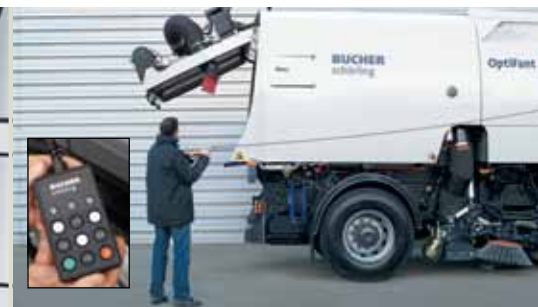
Commande à distance de la cuve à déchets
