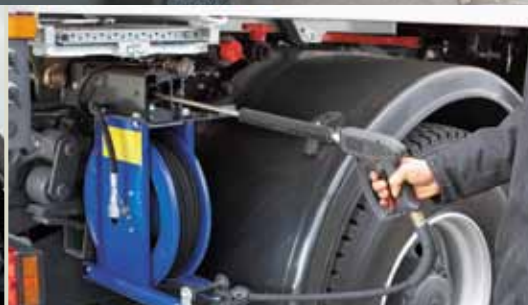
Installation de lavage haute pression avec lance manuelle
