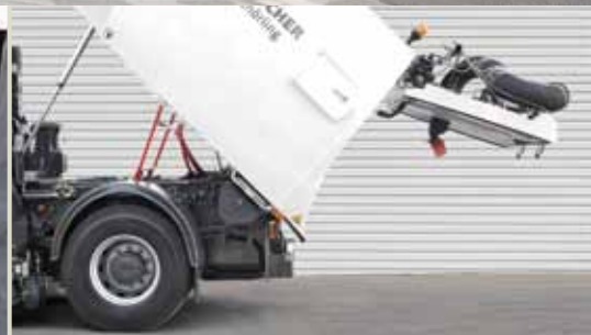
Vidage rapide de la cuve à déchets
