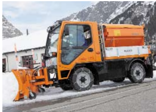
Der Klassiker Ladog mit Schneepflug und Salzstreuer, optimal zur Räumung von Fahr- und Gehwegen sowie von grossen Flächen.
